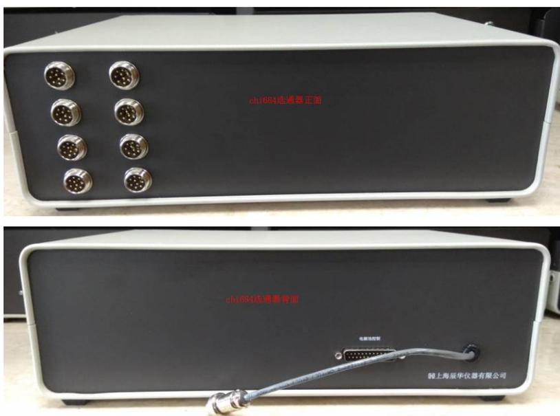
CHI684 多通道选通器可与 400/400A 系列，600A/B/C/D/E 系列，700A/B/C/D/E 系列以及 800B/C/D 系列联用。选通器控制四根电极线(对于 400/A/B/C,600A/B/C/D/E 为工作，感受，参比，对极，对于 700A/B/C/D/E 和 800B/C/D 为工作，第二工作，参比，对极)。最多可以控制 64 个电解池，但每次只能选通一个电解池。
