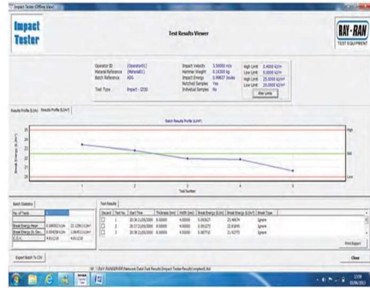
测试结果也可显示为表格，可以进行快速的结果处理和比较分析。样品的统计数据，例如：平均值、差异系数都显示表格中，并随测试进行更新。
