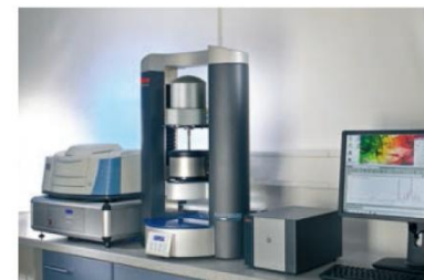
带 Rheonaut 模块和 Thermo Scientific™ Nicolet™ iS™10 FT-IR 光谱仪的模块化流变平台 HAAKE MARS。
