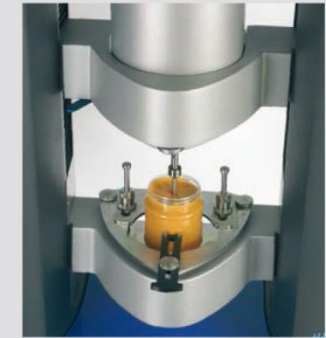
采用 HAAKE MARS、通用容器夹持器和叶片转子测试花生酱。
