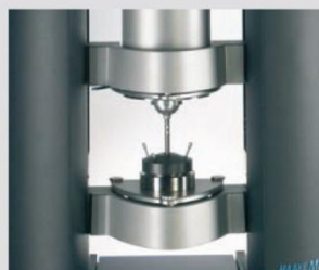
配备 Peltier 温度模块、平行板和样品罩及溶液封环的 HAAKE MARS。
