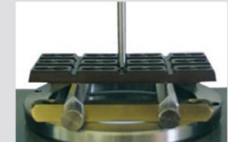
采用弯曲断裂工具分析巧克力棒的纹理。
