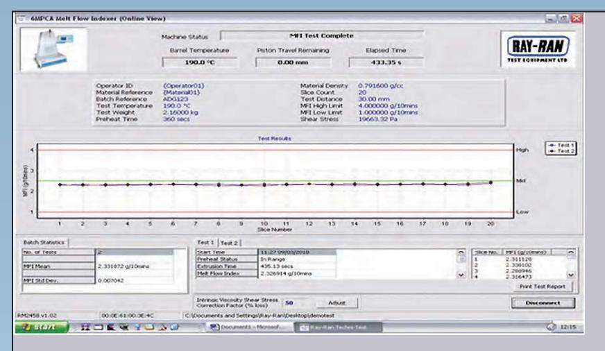
在测试结果查看模式下，用户可以上传保存的材料，与先前进行的测试结果进行比较、数据处理或文件导出。例如：由于熔融材料内包含气泡而造成的异常结果是可以明确鉴定的，可以将其从测试数据中删除，确保批量处理统计到正常范围内，而测试程序不需要重复，从而节省了时间和材料。
