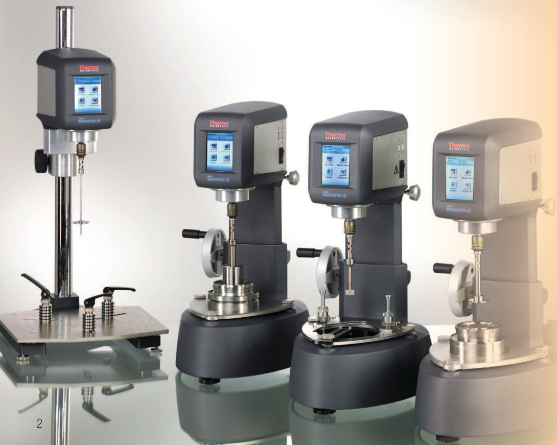
一台流变仪，多项流变任务：HAAKE Viscotester iQ 流变仪可随时用于您所需的任何配置中
