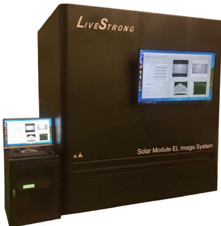
在太陽能模組的生產與發電應用過程中，產品需經過檢驗方能確保其品質。目前的檢測方式分為兩類，一為電性檢測，一為外觀缺陷檢測；其中太陽能模組若有微裂(micro-crack)、斷線、破片、不均勻等缺陷，從電性測試大多無法直接檢出，但此類缺陷會對模組功能產生不良的影響。利用太陽能電池模組的電致發光特性，再利用可偵測近紅外光的相機，取得電致發光影像。電致發光影像可呈現太陽能電池模組的材料瑕疵(Material defect)、燒結(Sintering wave)、製程污染(Contamination)、微裂(Micro crack)，以及線路斷路(Broken finger)等缺陷。
