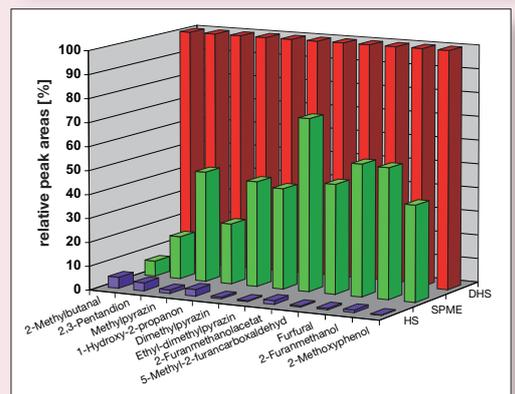
使用动态顶空, 顶空固相微萃取和静态顶空法分析咖啡粉
