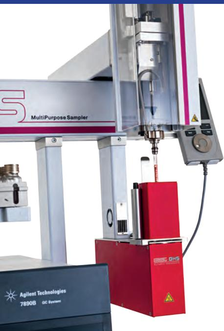
动态顶空技术结合了吹扫捕集法的高灵敏度，低检测下限的优点，并且拥有传统顶空法操作简单，高通量及耐久性的特点
