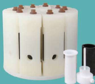
十位独立框架超高压消解罐架
