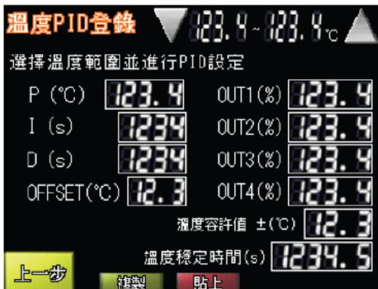
设备可在 100~410°C 之间，设定 31 个不同的测试温度，方便随时调用。其中设定分辨率为 0.1°C，温度精度为 ±0.1°C
