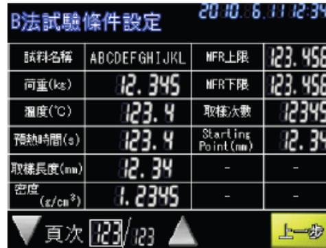
设备可存储 A、B 法测试条件各 100 组
