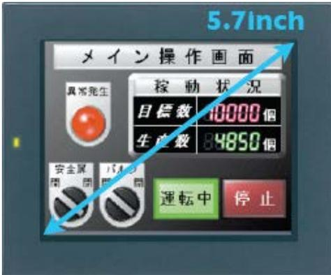
熔指仪配有 5.7 英寸超大液晶触摸控制面板
