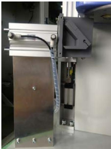
熔指仪采用推刀进行自动切割试料，相比普通的转刀力度更大，同时可以防止切断试料四处飞溅。
