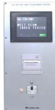
熔指仪可选配内嵌式的微型打印机，不仅可以打印测试条件及相应结果，同时也可输出相应 A、B 法测试曲线
