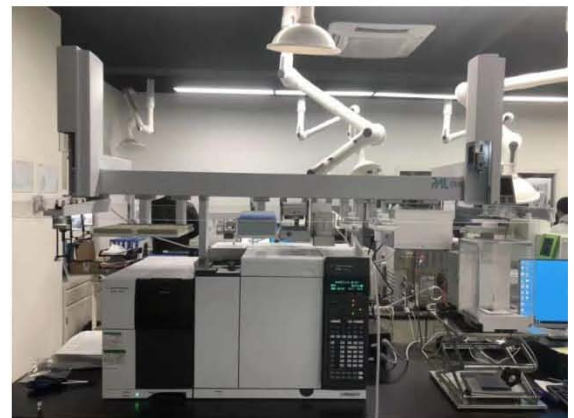
DHR 双臂多功能前处理平台与气质联用 含在线称量、离心、移液、稀释、配标曲等
