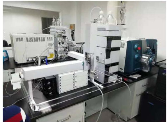
多功能进样器连接 AB 质谱联用 Load Ahead 功能，96 位控温样品盘
