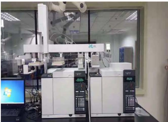
多功能前处理平台同时为两台气相色谱进样
