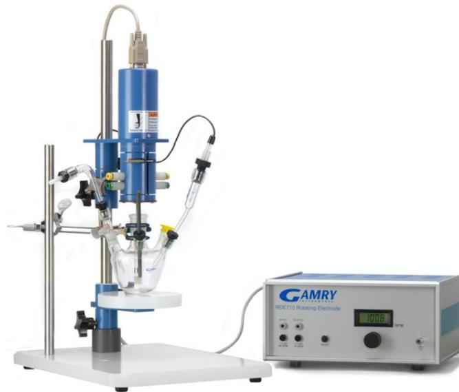
RDE710 旋转电极是研究级的旋转器，其特征是能够使用旋转环盘电极、圆盘电极和柱面电极。转速可在 50 至 10,000 rpm（每分钟转数）间调整。控制器配备了可显示转速的液晶显示屏 (LCD)，该显示屏由转速旋钮进行控制。或者，也可以通过您的 Gamry 来控制转速。旋转器的电极装置采用通用设计，可应用于不同的电极类型。根据您所需的用途，可以选择不同的轴和电极头。不同的轴可用于圆盘电极和柱体实验（部件号 970-07）或环盘电极实验（部件号 970-10）。
