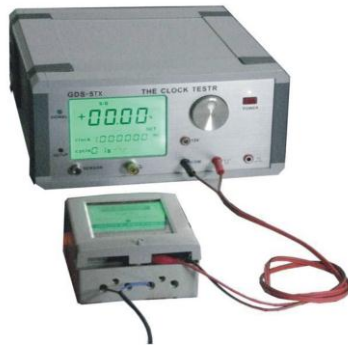
图 9. GDS-5TX 连接电能表
