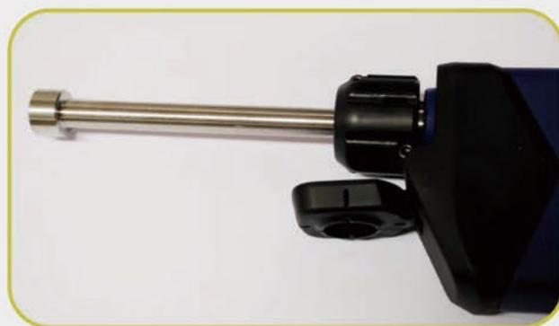
必须注意确保在装配过程中MIDASMETER和波导管上的螺纹连接不会损坏。必须在传感器面和波导管之间放置一层硅脂，以充当耦合剂以排出所有空气。
