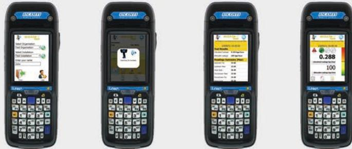
可以使用 MIDASMeter@Communicator 应用程序将PDA轻松连接到PC端，该应用程序可导入阀门检测期间收集的所有信息，提供备份，并可生成标准图形和报告显示阀门状态。 这些报告的结果可以用于确定维护预算和阀门的修复措施，并明确优先级，从而实现最大的收益。
