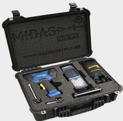
MIDAS Meter超声泄漏检测仪小巧便携，使用方便。它采用声发射传感器，通过检测泄漏流体产生的高频噪声来发现并量化阀门泄漏。此超声泄漏检测仪不仅可以快速地找到泄漏的切断阀、控制阀、止回阀、安全阀和蒸汽阀，它还允许人员对阀门性能进行测试，并通过PDA在现场提供数据存储、分析和报告。通过这种先进的阀门状态检测，可用于预测性维护活动，使您从被动维护变成主动维护。而且，阀门泄漏检测设备有助于将预算支出和行动集中在能够带来最大效益的阀门上。
