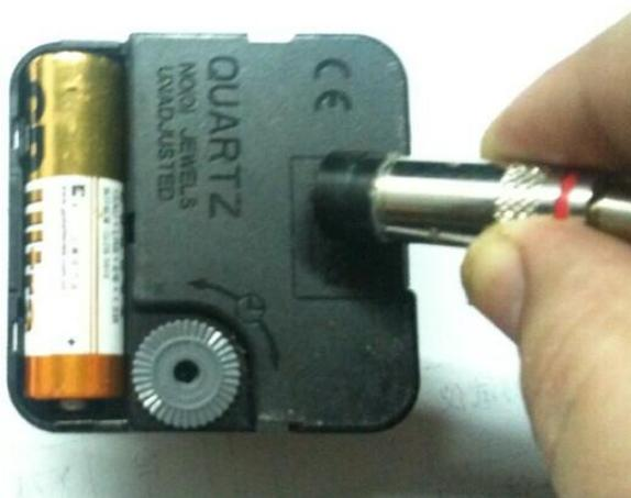
图 8. 探头测量石英机芯
