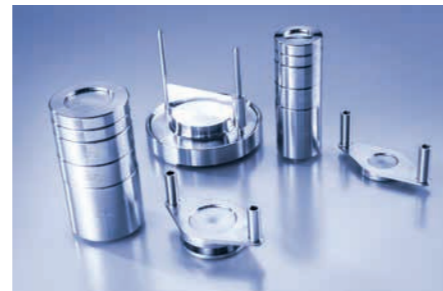
大小剪切池的制备台和承重可用于时间压密测试, 而无需占用流变仪
