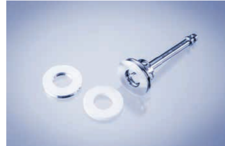
壁摩擦测量系统, 配备可轻松更换的盘
