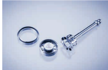
小剪切池, 可容纳 4.3 mL 样品, 适合小颗粒、珍贵样品, 法向荷载最高 30 kPa
