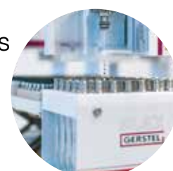
MPS robotic 托盘架，放置了40位的ALEX衬管托盘（最前部）以及54位的2 mL小瓶托盘。
