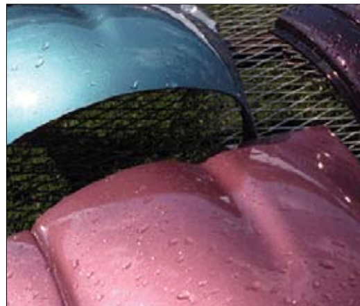
使用独特的冷凝机理，QUV 可产生导致户外潮湿的主要因素-露水。
