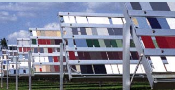
Q-Lab 佛罗里达曝晒场的样品架
