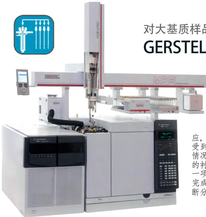
在几次进样之后，脏的基质样品可能导致 GC 进样口衬管有显著的污染。可能导致峰展宽、分析物歧视和其他基质的累积效应，而使分析数据的质量受到影响。为了避免这种情况，应定期更换进样口的衬管。一般衬管更换是一项需要几个手动步骤来完成的任务，并且需要中断分析序列，这使得在没
