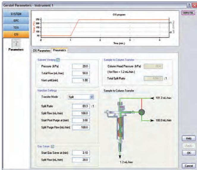
如果使用GERSTEL的气路ePneumatics来控制CIS MAESTRO方法屏可提供“一目了然”的参数图示包括分流比和相应的气流大小。
