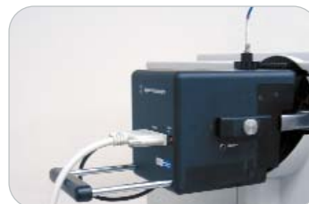
脉冲动态聚焦基质辅助激光解吸源 (PDF-MALDI)
