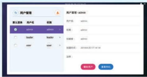
分析软件采用安卓系统设计开发，使用方便，功能强大，具有电子签名、分级权限和审计追踪等功能，符合FDA 21 CFR Part 11中相关规定。8G本地存储空间，内置专家方法库，7寸液晶触摸屏能够实时显示工作时的温压变化曲线。软件可自动识别转盘型号，自动进行罐数统计，以避免人工计数和输入的繁琐，使实验更轻松更便捷。
