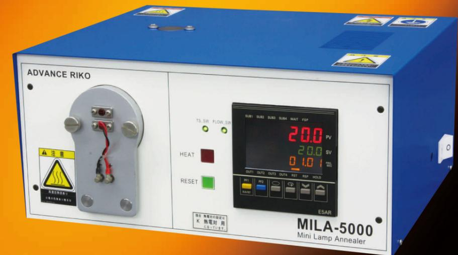
快速热处理 (RTP) 已经成为半导体、铁电体以及薄膜器件的重要退火技术。但是目前, 只有大型的、昂贵的生产设备才能完成快速热处理, 这大大降低了研发工作的效率 (尤其是小的样品)。为了满足市场的需求, ADVANCED RIKO 研发出 MILA-5000 系列的小型快速退火炉。此系列的设备包含红外金面反射炉和高精度的温度控制器。根据需求选配相应的泵和气体接口, MILA 能提供与大型 RTP 设备相同的热处理性能。
