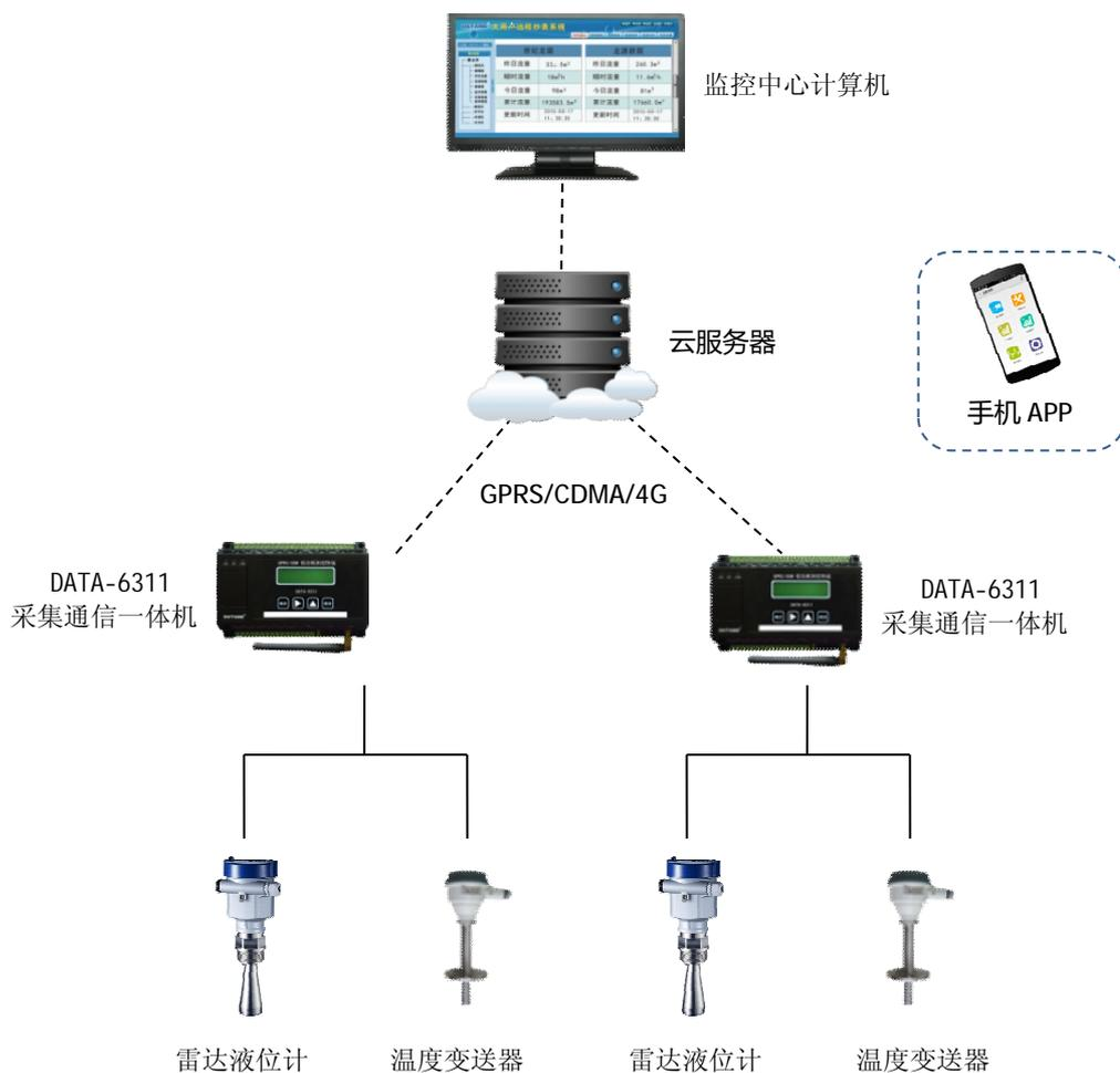
油罐液位、温度在线监测系统拓扑图
