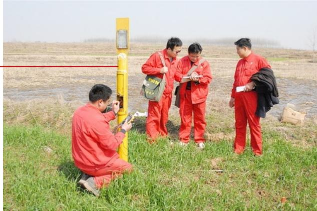
以往，阴极保护测试桩多依靠万用表及测试仪以人工方式进行检测（如上图所示），效率低、可靠性差、危险性高，难以满足管道阴极保护监测的需求。
