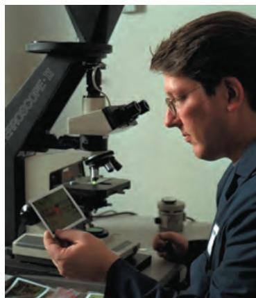
T2FM500是一套完整的铁谱分析系统，用以分离和评定在用润滑油、液压油、冷却液或燃油中的磨损颗粒和污染物颗粒，由薺管式铁谱仪、显微镜、工业摄像头、加热盘（可选）和图像采集软件组成。为了确保谱片的制作质量，经稀释处理后的被测油液在自身重力作用下直接通过薺型管，匀速流过铁谱谱片，油液中铁磁性颗粒在磁场作用下被沉积到谱片上，有效避免了制谱过程中外界作用力对磨粒造成的破损、变形等伤害；通过控制清洁溶剂的流量和流速，对谱片进行彻底冲洗；谱片干燥后进行分析。将制备好的谱片平稳的安装在显微镜的载样台，通过使用显微镜的透射光、反射光、偏振光、红绿光源以及加热等分析手段，参照标准的磨粒图谱，对磨损颗粒进行深入分析。
