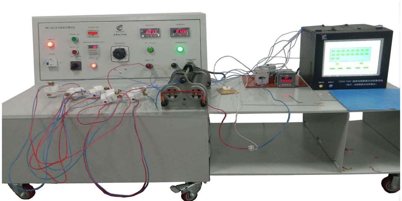
以上是测试额定电流为 10A 的 5 个公牛旅行转换器在测试电流为 12.5A,横截面积为 1.5mm<sup>2</sup> 长度为 1m 导线连接时的工作状态(BS8546 标准规定温升测试电流=额定电流\*1.25 倍)。
