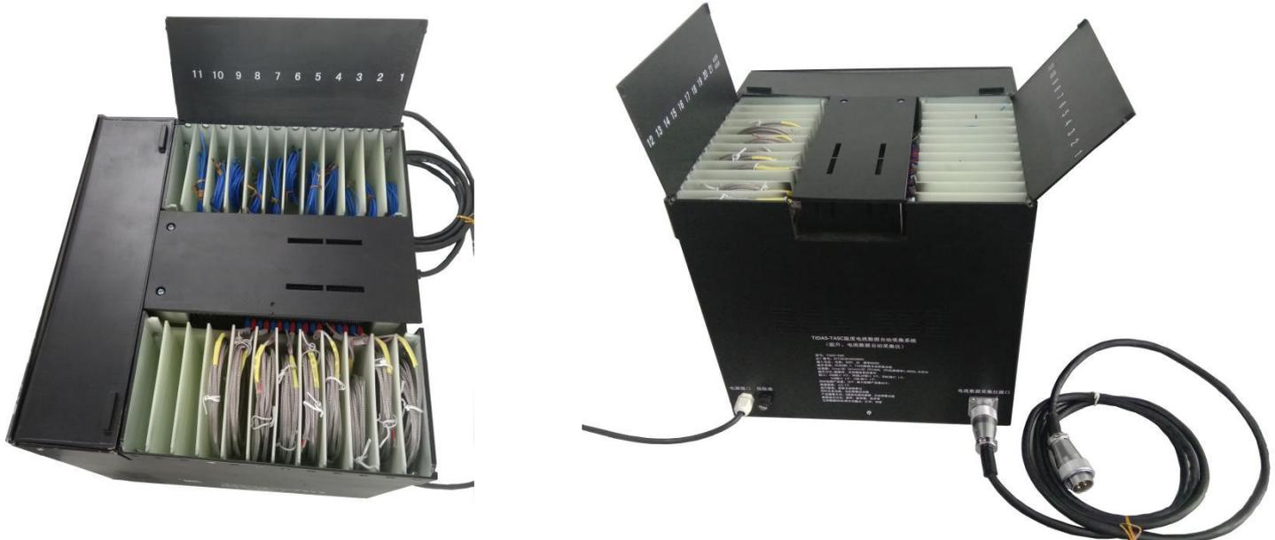
从上面视图可看出本数据采集系统上面有 24 个槽盒，槽盒里面装的是 K 型热电偶线，热电偶线穿过两侧的孔，以
