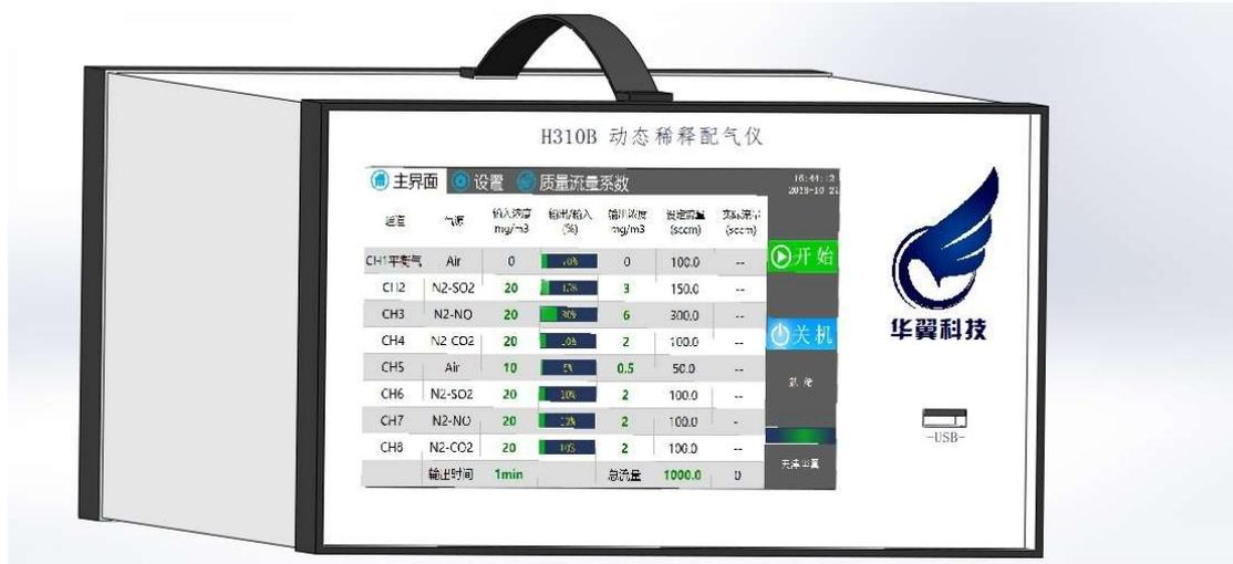
H310(B)动态稀释配气仪（以下简称配气仪），应用微型工控机和质量流量控制器技术，宽动态范围快速而精确控制气体流量，能实时配制不同种类、不同浓度的多组份混合气体。
