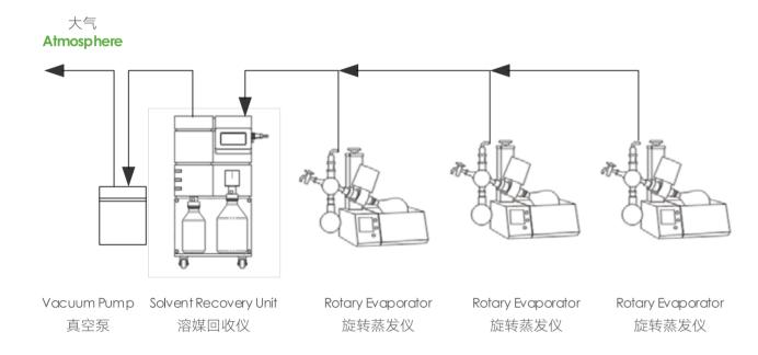
**溶媒回收仪与旋转蒸发仪联用**,不需要添加冷却循 环液,也不需要外接玻璃冷凝器,使用者不再担心 玻璃器件易碎问题,也避免了复杂管路的连接,更 有利于实验室的干净整洁。
