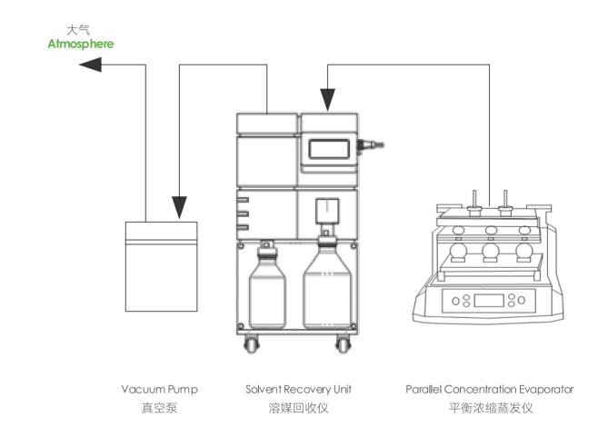
溶媒回收仪与平行浓缩蒸发仪联用,不需要添加冷却循环液,也不需要外接玻璃冷凝器,可以满足3000mL大体积溶剂蒸发冷凝回收需求,溶剂回收仪进气接口高度为25cm,低于平行浓缩蒸发仪输出接口,保证连接管路中的冷凝液全部被收集,防止释放真空时液体回流污染样品。
