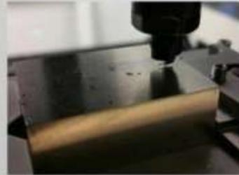
用于划痕深度测量的原位电容传感器
