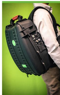
Picarro的GasScouter重量仅有23磅（10.4千克），耗电功率仅有25瓦。所有必要组件都集成在一个宽14英寸（35.6厘米）、厚7英寸（17.7厘米）、高18.3英寸（46.4厘米）的紧凑型背包里。一块223瓦时的可充电锂电池能让仪器连续工作超过8个小时，并允许在不间断工作状态下切换电池。
