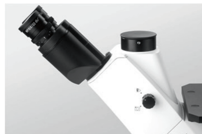
两档转换式观察筒：100% 观察；20% 观察，同时 80% 摄影
