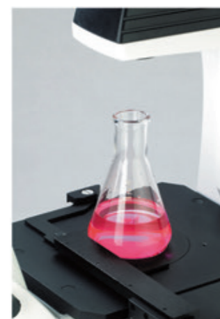
移除聚光镜，工作距 195mm 便于观察超高培养瓶
