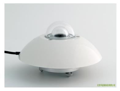
SR11 用于测量一个平面上的太阳辐射通量,单位为 W/m2,可视角度为 180°。传感器为完全被动工作,采用的是热电堆原理,SR11 测量输出为很小的电压,输出电压值和辐射通量是成比例的。
