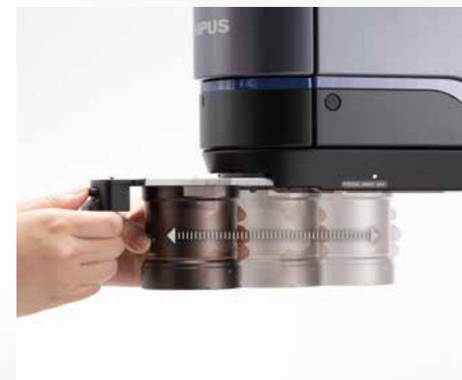
通过滑动式鼻轮快速切换物镜
