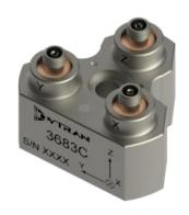
特征: 电荷式,外壳隔离,方便的 360°中心螺栓安装,定制的直角电缆 60061A 可用,密封,钛合金。
