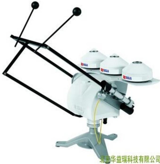
因辐射传感器观测视野的限制，无法进行全向观测，而太阳的位置是在时刻不停地变化的。为了使辐射传感器，尤其是在测量直接辐射时，能够准确指向太阳，保证测量的准确性，用户可以为观测仪器配备太阳跟踪器。
