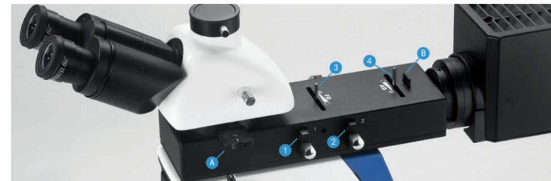
A. 检偏器 B. 磨砂玻璃插件 1. 起偏器 2. 滤光片转换推板 3. 视场光栏 4. 孔径光栏
