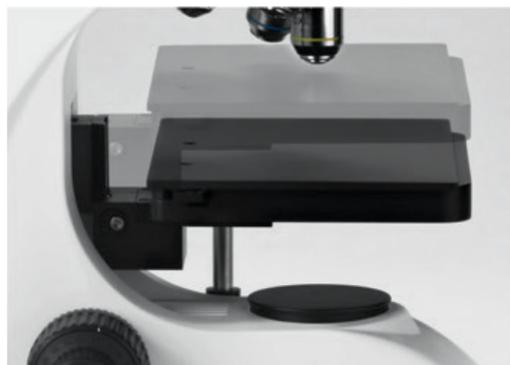
平台快降装置, 可使被检样品的观察空间增加 50mm 以上高度, 便于观察大型样品
