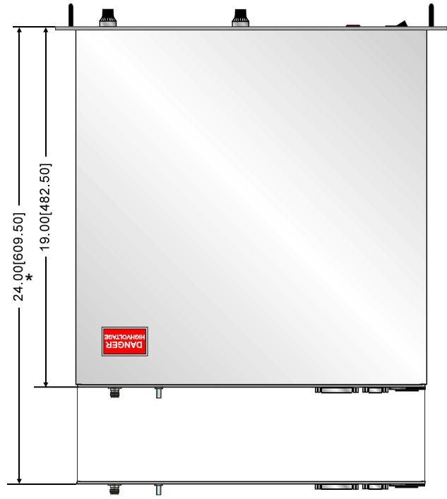
\* 高压输出80~130kV时机箱长度为609.5mm
