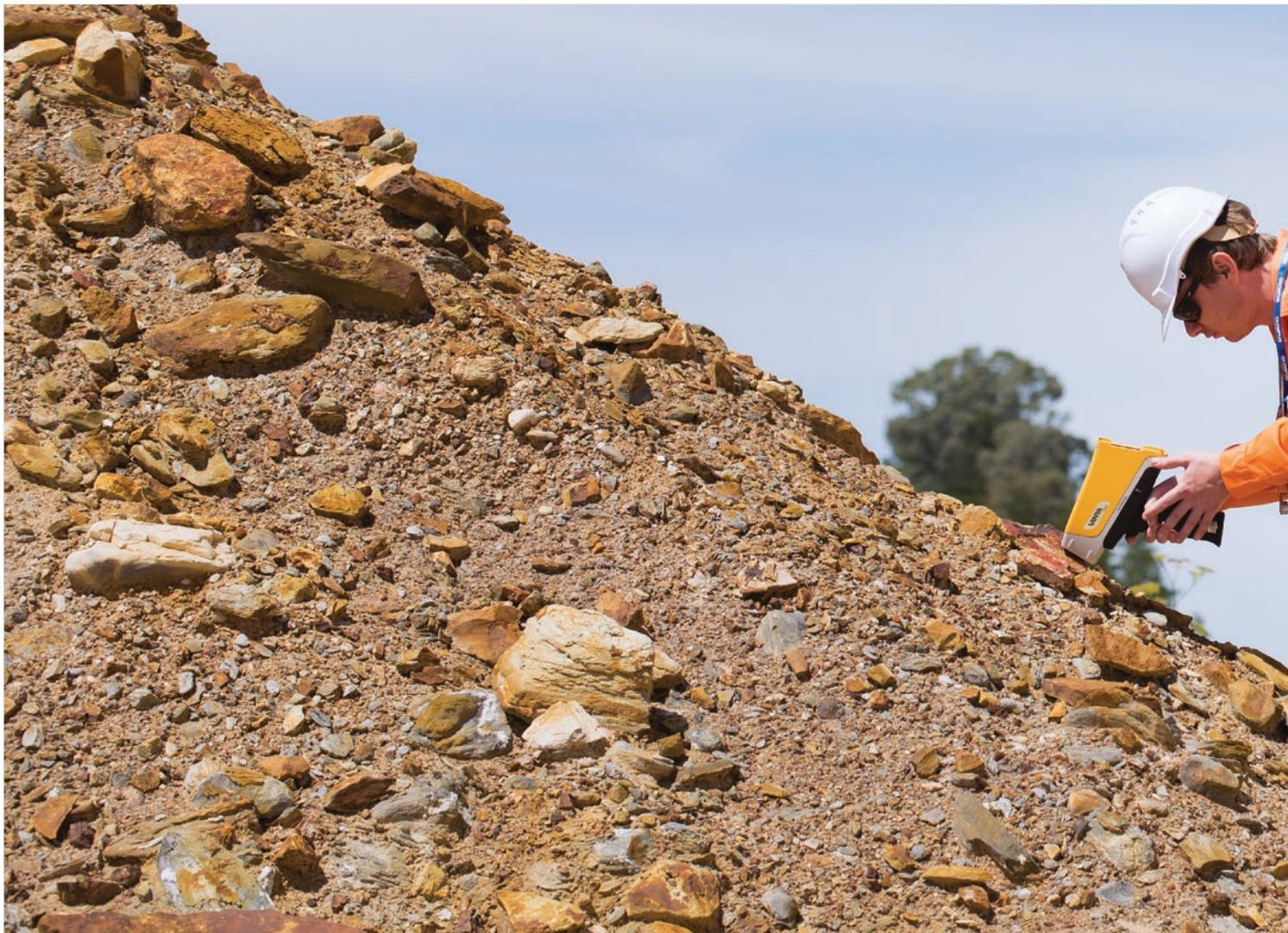
奥林巴斯Vanta手持式XRF分析仪可以在现场进行即时元素测量，完成一系列地球化学应用。在矿产资源的整个开发周期中，Vanta分析仪都可以为用户提供强大的性能和很高的灵活性：
