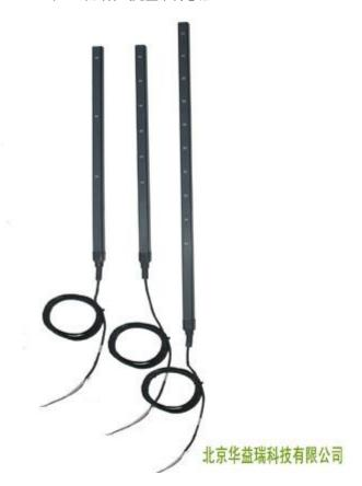
Apogee 公司生产的 MQ300 系列杆式光量子传感器,用户可以根据自己的需要选择合适数量的传感器进行测量。在一根 50 厘米长的杆上,平均布置了 3 个或 6 个光量子传感器,组成了 MQ303 和 MQ306;在一个根 70 厘米长的杆上,平均布置了 10 个传感器,组成了 MQ301。
