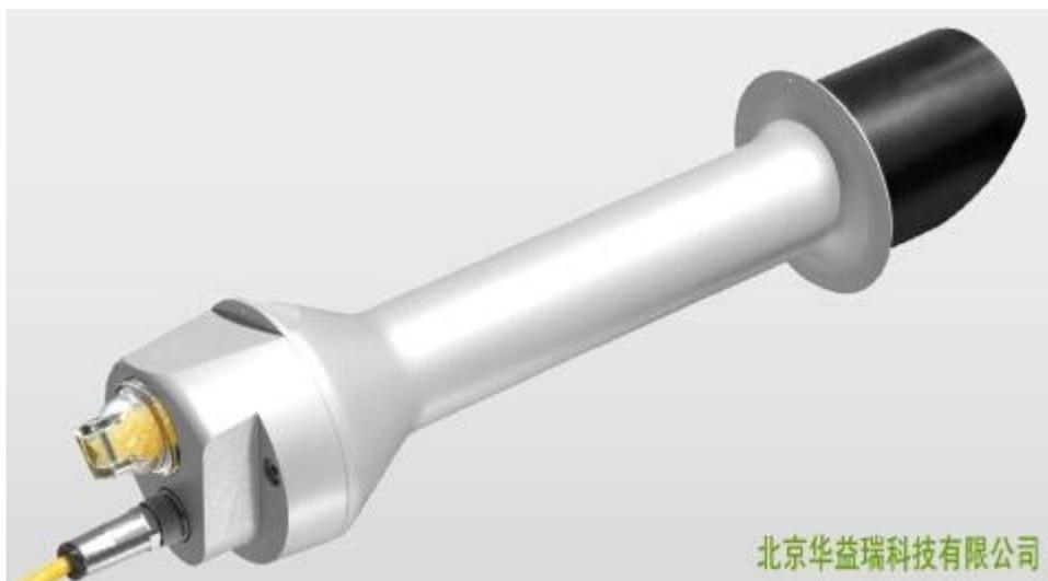
SHP1 是 Kipp&Zonen 以 CHP1 为基础，应用\*新的智能型数据接口技术而研发的新型智能型直接日射强度计（直接辐射表），符合 ISO9060 的上等标准（first class）。智能型数据接口不仅可以提供多种数据输出方式，其集成的温度传感器和数字多项式函数程序，还能在 $-40^{\circ}\text{C}\sim 70^{\circ}\text{C}$ 的温度范围内为直接日射强度计自身提供温度修正，减少外界干扰，确保测量数据的准确性。
