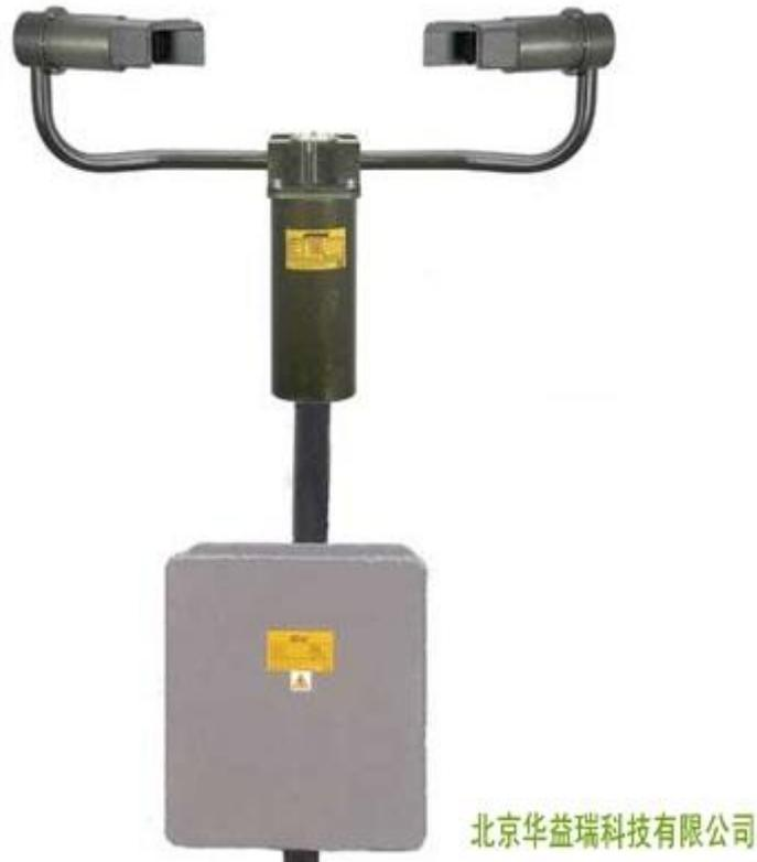
HSS VF-500 能见度/雾密度传感器对于实现数据采集目的、自动测量报警都是非常理想的。传感器主要用于\*\*测量高密度大雾，而且传感器应用了 20 多项眼睛和技术，是一个紧凑的、耐用的、具有卓越性能的[能见度传感器](#)。
