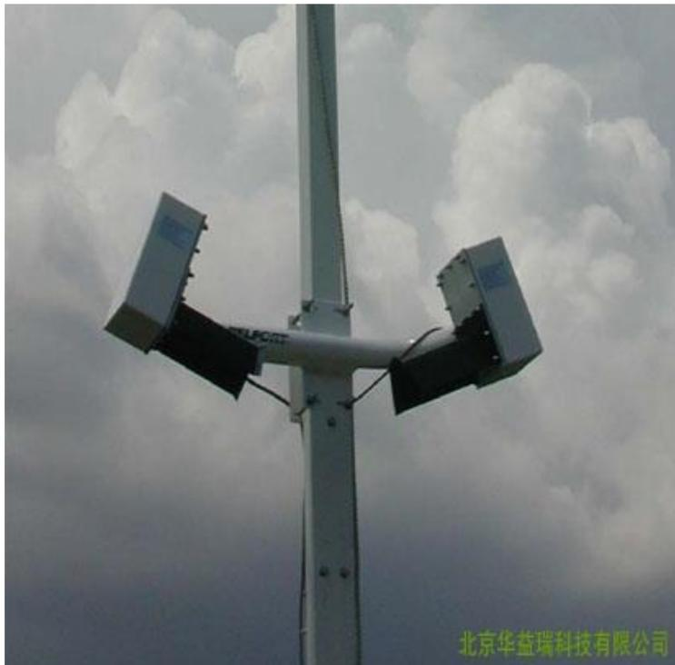
6000 能见度传感器用于监测能见度状况，测量范围为 0—80Km。6000 有模拟量输出和数字量输出，模拟量输出为 0—1，0—5 或 0—10V 以及 4—20 mA 可选。同时还有报警输出，报警可以被调整为用户当前能见度开始端。标准含有两个报警通道，可以指示好/中/差能见度。数字 RS232 和 RS485 输出，波特率为 300—38400，可提供诊断信息。
