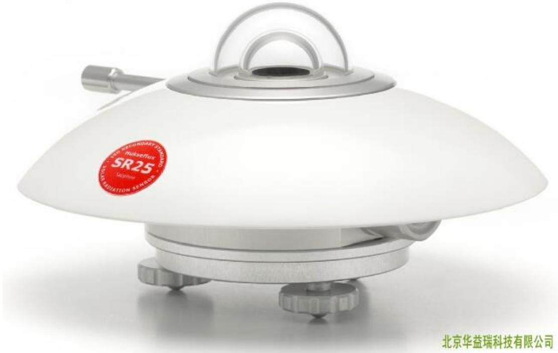
SR25-D1 将太阳总辐射测量更\*\*，使其上升到新的测量水平，辐射表头使用蓝宝石的外穹顶,零偏移量可以忽略不计。SR25-D1 加热为了抑制露和霜沉积,保持其测量精度。当加热的时候 SR25-D1 数据可用性和准确性高于传统辐射表。此外,SR25 的通风功耗非常低,它只消耗 1.5 W 相比通常的 10 W 通风要优势很多。
