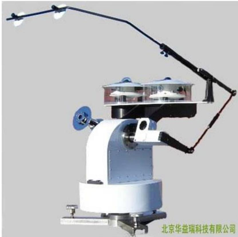
SMT3 两轴自动跟踪定位器设备是一个全天候运行设备,可以用来作为太阳跟踪的直接辐射和散射辐射测量,也可以对长波测量的太阳影响部分进行遮挡。它具有稳定性好,精度高等优点。
