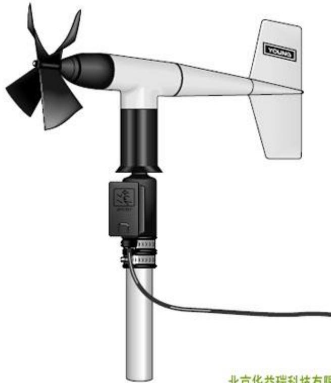
05103 是一款高性能风传感器，耐用的，抗腐蚀的结构使其在各种测量应用上变得非常理想。风速传感器是一个四开口螺旋面螺旋桨，螺旋桨旋转产生交流正弦波电压信号。风向传感器是一个耐用的、重量很轻的风向标，风向标的角度通过一个精密的电位计来感知。
