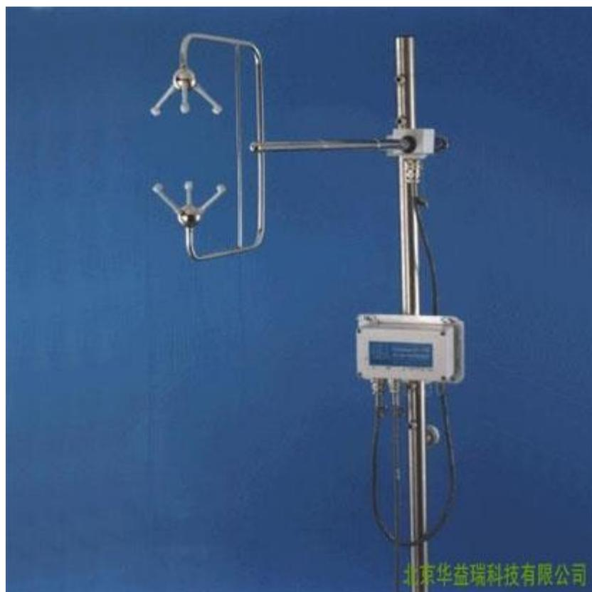
Solent 研究级 HS-50 三维超声风速风向仪是根据研究者的实际需要设计的，水平方向对称的声头使得仪器可以进行\*\*的垂直流动测量，风速计的几何学设计\*小化了其它因素的影响。
