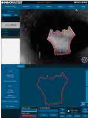
作为一个选配功能，完整轮廓或片段轮廓通过图像扫描进行识别。基于所获取的图像，通过特定数量，或点距离边缘的距离来编程所有测试点。不论试件尺寸的大小，均可全自动进行测试和测量每一压痕位置。用户可将此优秀功能同焊缝测试软件和**CHD**测试软件相结合，从而获取符合测试报告要求的所有数据。该功能可有效节约用户的测试时间和金钱投入，并可避免人为误操作。
