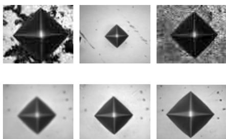
IMPRESSIONS™ 测量系统可独立于操作者，自动评估图像的清晰度和亮度，并对压痕进行测量。
