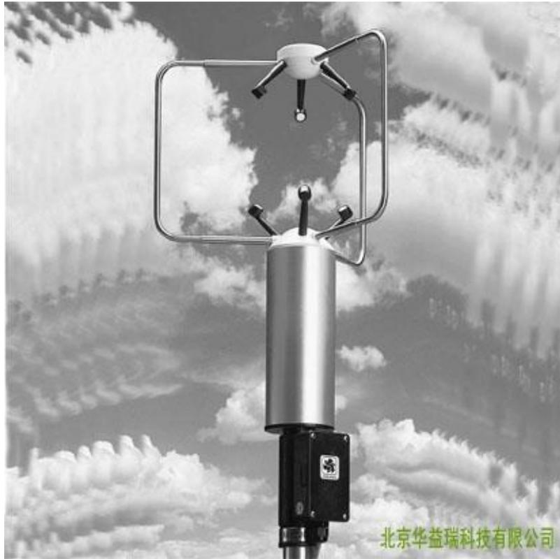
基于声速信号的传输时间，81000 型风速仪测量三维风速，由声速的测量可获得声场温度，综合考虑声速及风场温度后，修正其影响。
