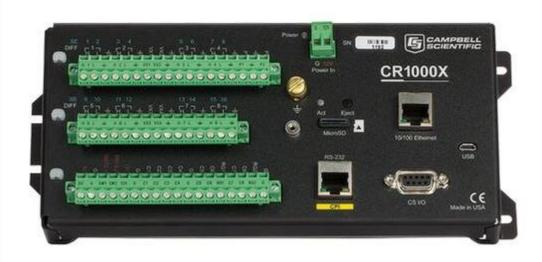
CPU: 32 位集成浮点运算单元,计算速度可达 100MHZ 内存: 128MB 闪存和 4MB 带内置供电的静态存储器 MicroSD 存储卡可扩展至 8GB 时钟精确: ±3 分钟每年,可 GPS 校时至 10 微秒 USB micro B 直连数采,2.0 传输速度,12Mbps 10/100 以太网 RJ45 接口用于 LAN 连接 CS I/0 端口用于 CSI 其它通讯设备或者显示设备 RS-232/CPI 端口用于通道扩展或者 Campbell 集成模块 CDM 协议支持: Pakbus, Modbus, DNP3, NTCIP, NMEA0183 等 可插拔电源端子用于连接干电池槽,PS150,PS200 或其它供电系统 可控 12V 供电通道用于其它传感器或通讯设备供电,1.3A@-40°C,0.47A@80°C
