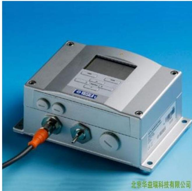
PTB330 系列数字气压表具有耐压、耐温范围广的特点。A 级气压表是经过精心调整、并由重力试验仪标定的。B 级气压表是由电子工作标准调校的。PTB330 系列压力表采用维萨拉研制的 BAROCAP 硅电容式优良压力传感器来测量大气压力，BAROCAP 传感器具有优异的无滞后、可重复、耐温变和长期稳定等特性。所有 PTB330 气压表出厂时均带有检定证书。
