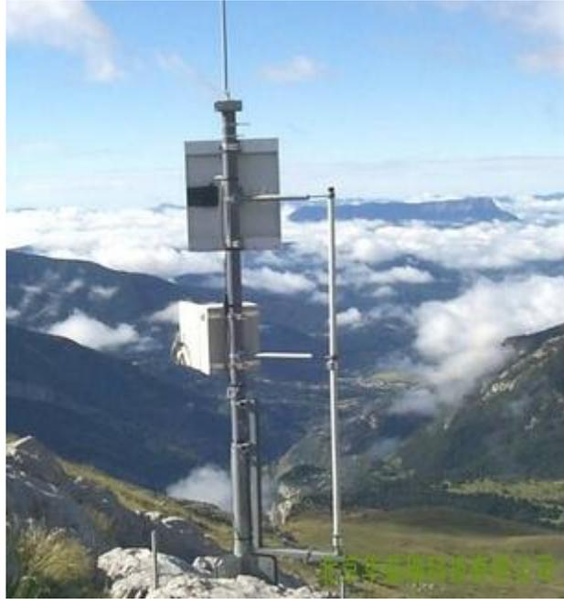
FlowCapt 由 3 个声压感应部件，1 个电子处理器（里面是集成好了的电路板和处理器）及相关线缆和数据线组成。
