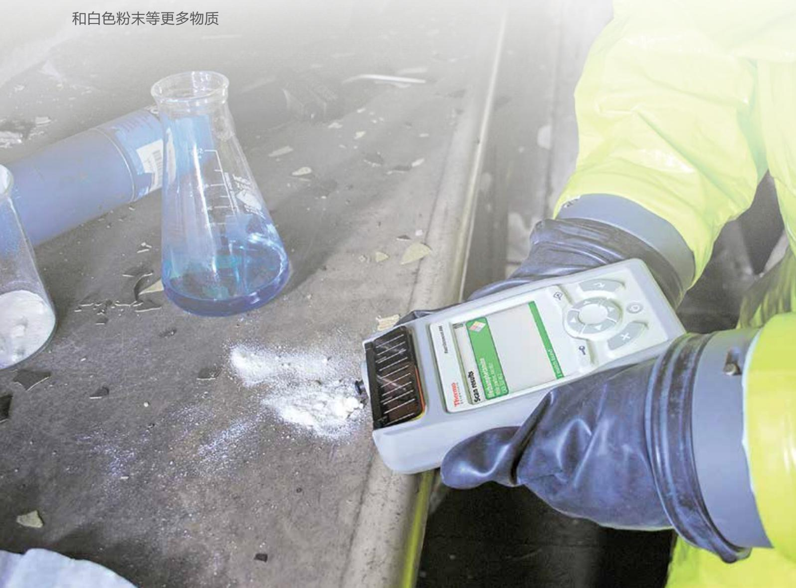
无需用户解析的颜色标识结果，为用户快速、明智的决策提供丰富的内容。通过专利算法可实现自动混合物分析（以蓝色的结果显示），被标签标记的物质将在屏幕上突出标记显示。内置的 NIOSH 和 CAMEO 指南中提供了详细危险信息。
